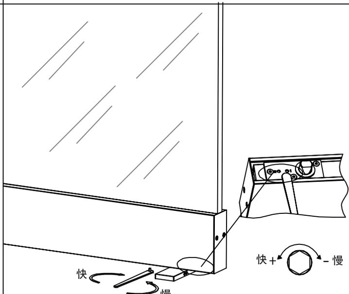
6. 調節地彈簧上的閥門螺絲，以求需要的關門速度及閉鎖速度。安裝完成。
