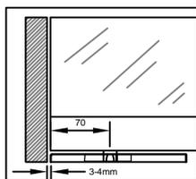
1. 確定地彈簧安裝位置，保證水平度與垂直度，根據場景以正確配件安裝地彈簧底座，完成後安裝面蓋。
