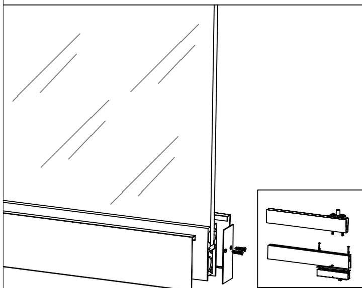
3. 安裝地彈簧及上軸於鋁型材內，並以螺絲固定。以玻璃膠將玻璃門扇與鋁框接合並使其牢固。
