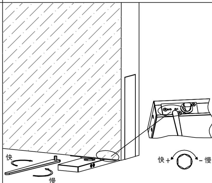
6. 調節地彈簧上的閥門螺絲，以求需要的關門速度及閉鎖速度。安裝面蓋，安裝完成。
