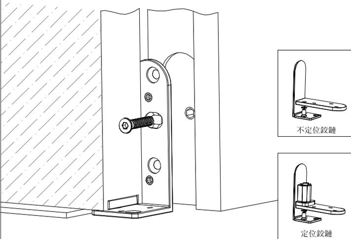
3. 墊起門扇，打開鉸鏈至 90°，下底座套入承重墊片並將鉸鏈底座以機牙螺絲安裝在門框上（上鉸鏈底座不需套入承重墊片）。
