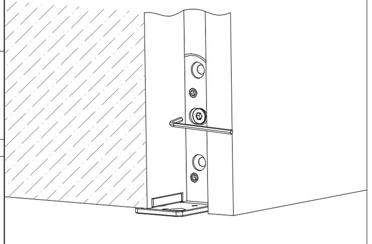
4. 略鬆機牙螺絲，手動調節門框方之內外垂直度，完成後收緊所有機牙螺絲。
